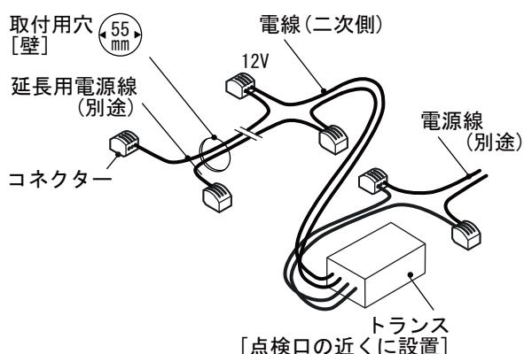
※トランスからランプまでの電線の長さは最長9mまでに設定してください。
