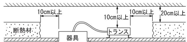
※ 住宅の断熱施工された天井には使用できません。法律で禁じられています。住宅以外の建物に使用するときは、上図のように行ってください。
