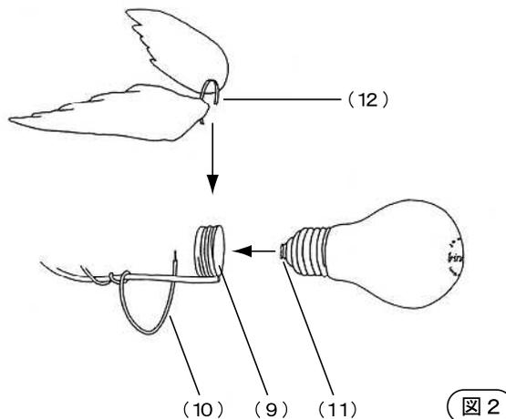
ソケット(9)に専用電球をねじ込み、スリーブ(11)に
