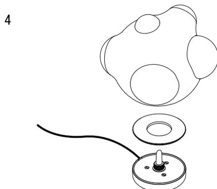
4 プレートアダプターの向きに注意してベースに置きます。ガラスグローブをゆっくりと回して取り付けてください。この際、強く締めすぎないでください。破損の原因となります。
