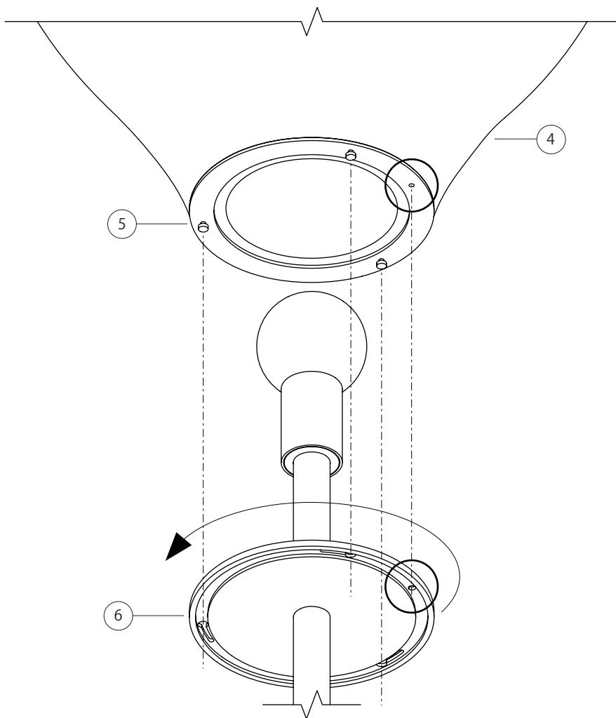
フランジの下側の穴にグローブ固定ネジ⑦を締めつけ、確実に固定してください。
