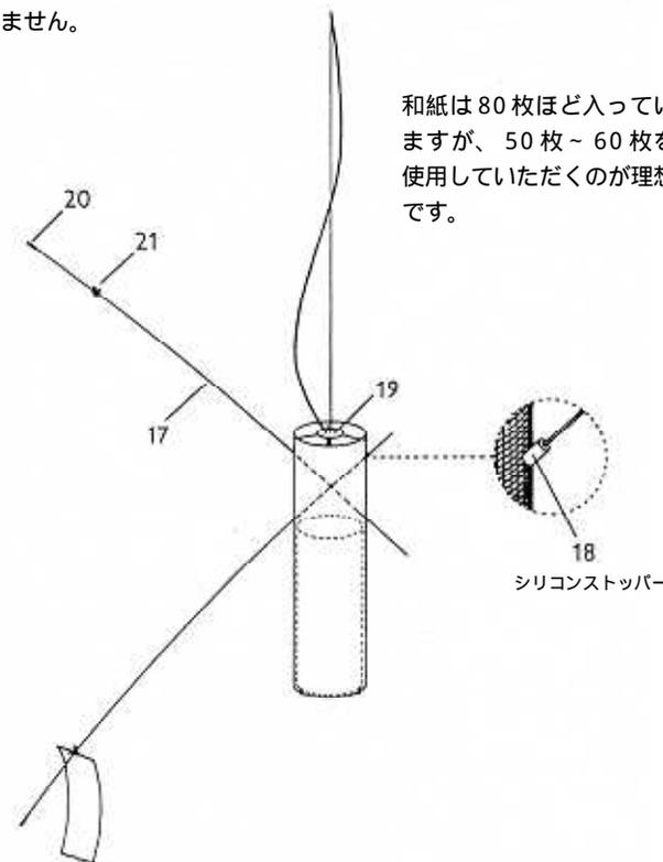
メタルメッシュカバーの上部にあるリング (19) の穴はロッドが3～5本用となりますが、この場合 10 cm 以上は差込まないでください。下から差す時は必ずシリコンストッパー (18) を使用してください。ロッド用プラスチックスリーブ (20) はロッドの 0.5 ~ 1 cm のところに付けてください。
