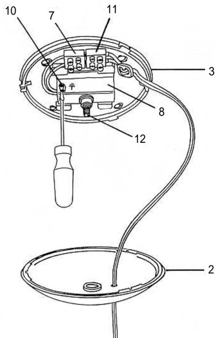
カバーを下から押し上げながらカチッというまで右回してプレートに差込みます。フック(1)を穴へしっかり差込み、そこに滑車(13)を引掛けます。
